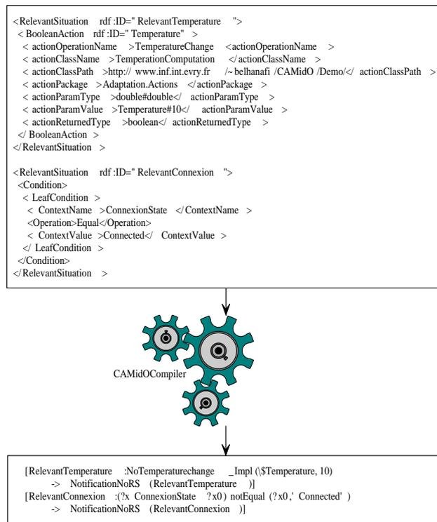
FIG. 4.22 – Exemple de génération de règles pour détecter la non existence de situation pertinente
