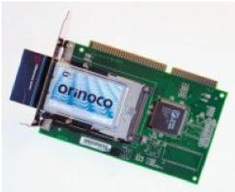
Figure 3-11 Adaptateur avec carte WLAN
